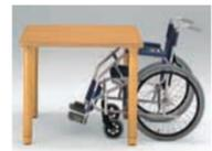
MB8N(脚:H670)にて、車椅子をご利用の場合は、ジョイントパーツ(CM9700)の装着により、天板下までの高さを標準的な車椅子の肘掛けが入る720mmに変更できます。装着の際はMB脚のアジャスターをCM9700に付け替えてご使用ください。(右図参照)
